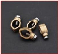
Ils assurent une connexion mécanique entre la câblette ou feuillard et le piquet de terre, les produits en contact étant tous aux mêmes potentiels il n'y aura pas de phénomène de corrosion galvanique. Réf : CPC1670/CPC2595/CPC30
