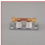
Elle se situe entre le piquet de terre et le compteur électrique. Son rôle est de scinder le circuit en 2 parties, la partie amont (du compteur vers les circuits prises, éclairages ...) et la partie aval vers le circuit de terre. Lors de la séparation du circuit cela vous permettra de mesurer la résistance de la prise de terre. Celle-ci doit être inférieure à 100 Ohm. Réf : BC1635/BC1670
