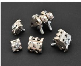
Les raccords à griffes laiton étamé où « crapauds » permettent de raccorder des conducteurs entre eux ou peuvent-être également utilisés pour fixer une cablette de terre ou une tresse de masse sur un chemin de câble en fil.
